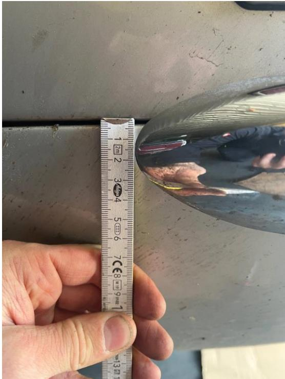
**INFO:** Zusätzlich werden verschiedene dicke Gummipuffer mitgeliefert, welche Sie sowohl vorne als auch hinten unter die seitlichen Stoßstangenhalter anbringen können. Dies dient zum einen dem Schutz der Karosserie, zum anderen dem Ausgleich von ungleichmäßigen Abständen, welche unserer Erfahrung immer wieder vorkommen können.
